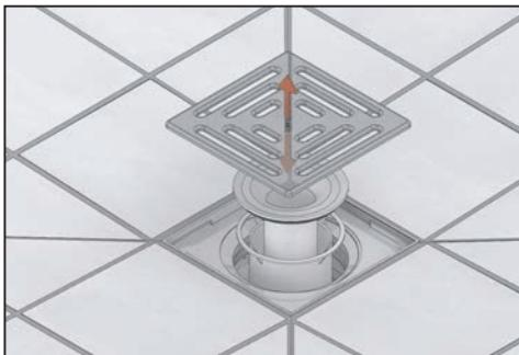
Zum Reinigen Geruchverschluss herausziehen, nicht drehen!
