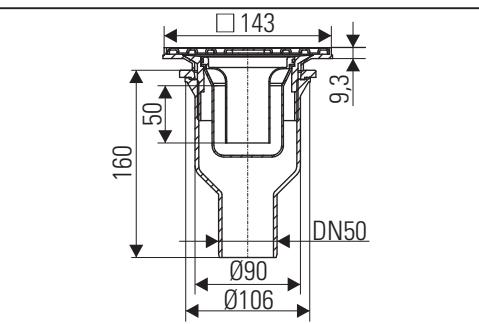
**Nur in Verbindung mit auf die Abläufe abgestimmten Bodenkonstruktionen oder Fertigelementen
