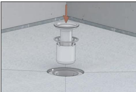
Geruchverschluss-Einsatz in das Schraubventil einsetzen,
