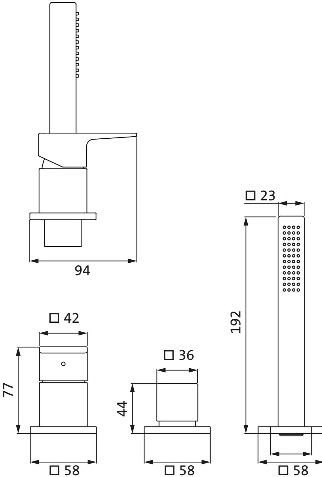
Lochbohrung  $\varnothing$  35 mm
