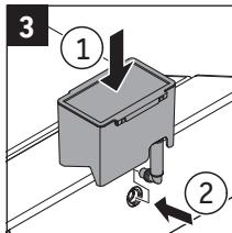
> Colocar el depósito en la carcasa e introducir el latigüillo por completo en la apertura.
