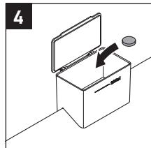
> Meter una tableta en el depósito.
