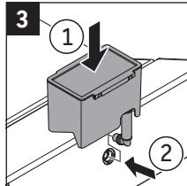
> Placer le réservoir sur le boîtier et introduire complètement le tuyau dans l'ouverture.
