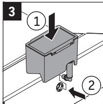
> Plaats de tank op de behuizing en breng de slang helemaal in de opening in.
