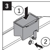
> Tank auf Gehäuse setzen und Schlauch komplett in Öffnung einführen.
