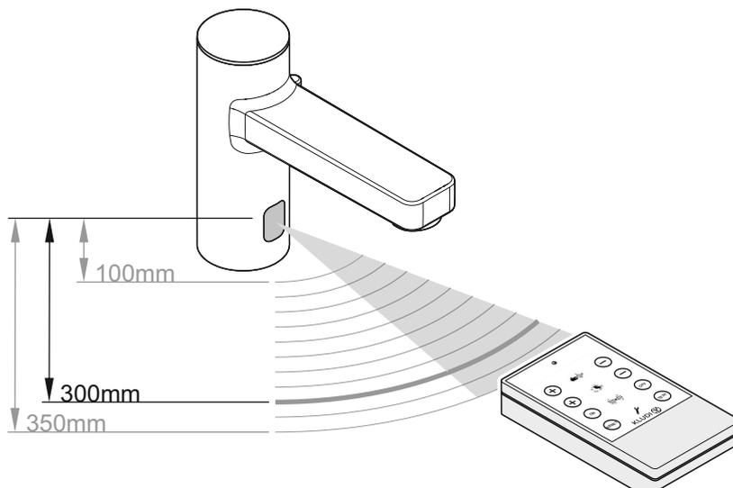
Mit der Fernbedienung Kludi 76790 kann der Sensor eingestellt werden.
